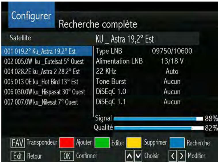
NB : Afin de faciliter le pointage de la parabole, le terminal est doté d'une fonction bip sonore.
