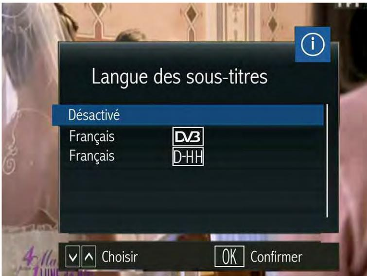
Lorsque les sous-titres sont émis par l'opérateur, une pression sur la touche SUB-T de la télécommande affiche le menu sous-titres.
